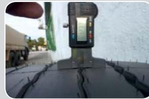
Die gemessene Profiltiefe in den engen Hauptprofilrillen dieses Neureifens beträgt 12,31 Millimeter.
