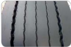
Der Neureifen weist an den Reifenschultern breitere Profilrillen als in der Mitte auf. Dies wirkt bei Neureifen unregelmäßigem Abrieb entgegen und trägt dazu bei, Kraftstoff zu sparen.
