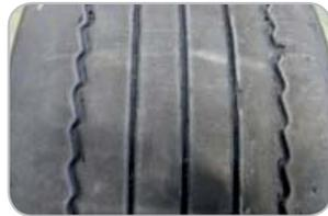
Ist der Reifen zu 2/3 abgefahren, haben sich die drei Hauptprofilrillen in der Mitte verändert, damit die guten Haftungseigenschaften auf nasser Fahrbahn bis zum letzten Millimeter bestehen bleiben.
